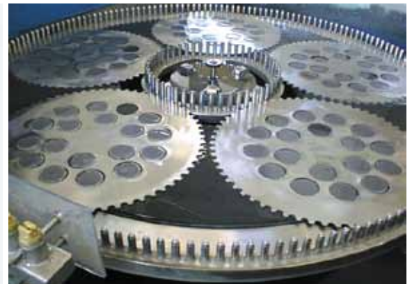
Meule de finition inférieure avec disques de support Mola di finitura inferiore con carriers porta pezzi
