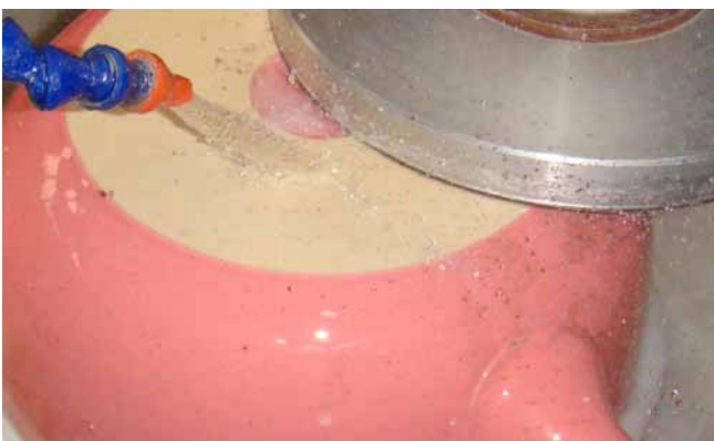
Schleifprozess der Fonduepfannen aus Keramik
